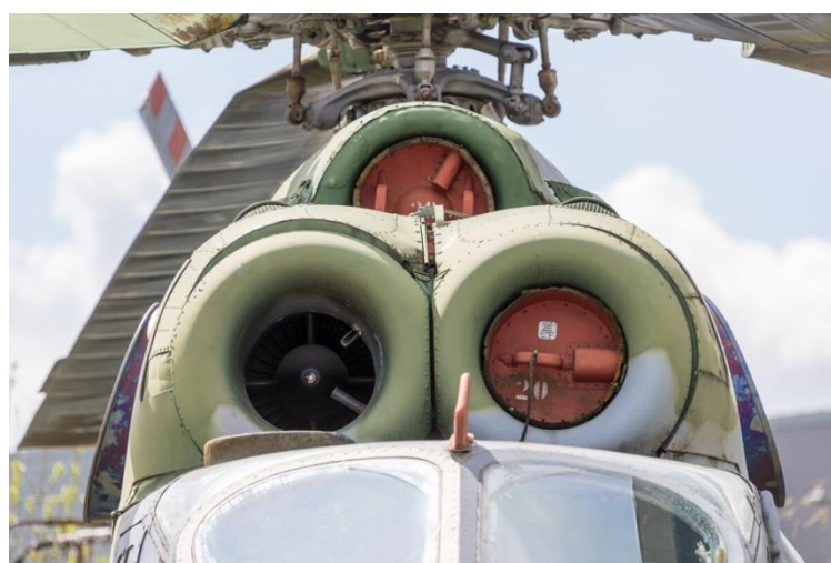
Рис. 4. Воздухозаборники двигателей и обдува главного редуктора.
