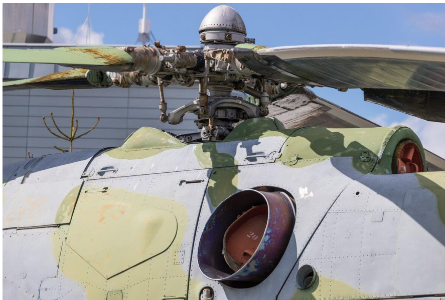
Рис. 6. Втулка несущего винта на вертолете Ми-24А сер. № 2201407.
