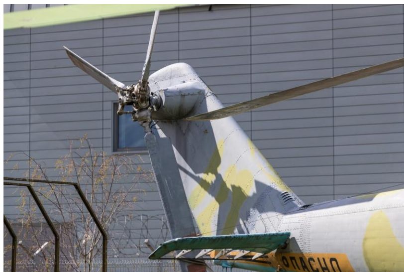
Рис. 8. Рулевой винт на правой стороне килевой балки вертолета Ми-24А.
