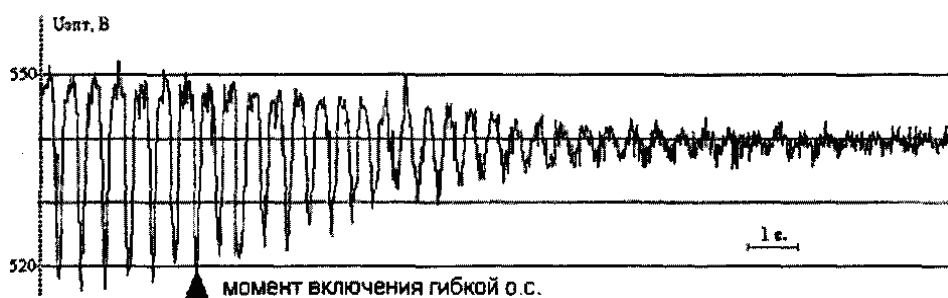
Рисунок 2. Осциллограмма напряжения звена постоянного тока.
