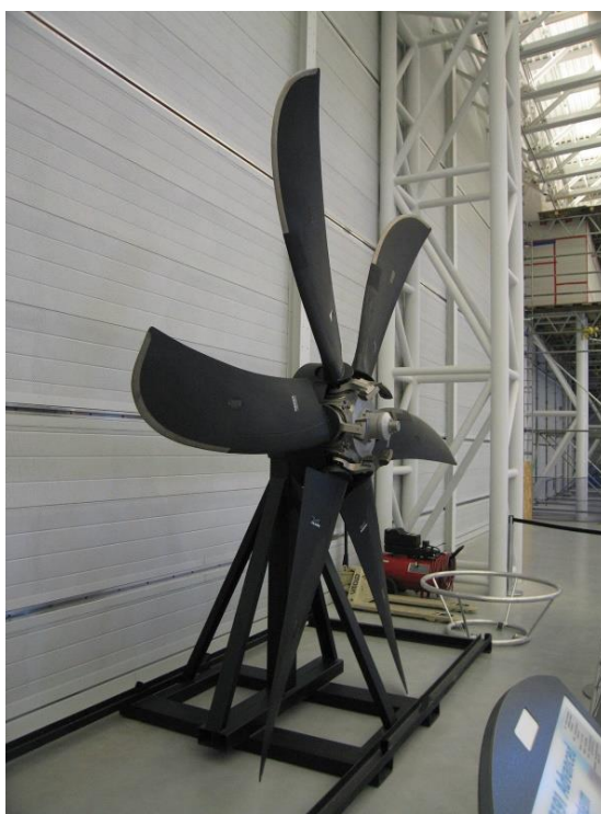
Рисунок 3. 6-ти лопастной пропеллер Dowty (фото из открытых источников).
