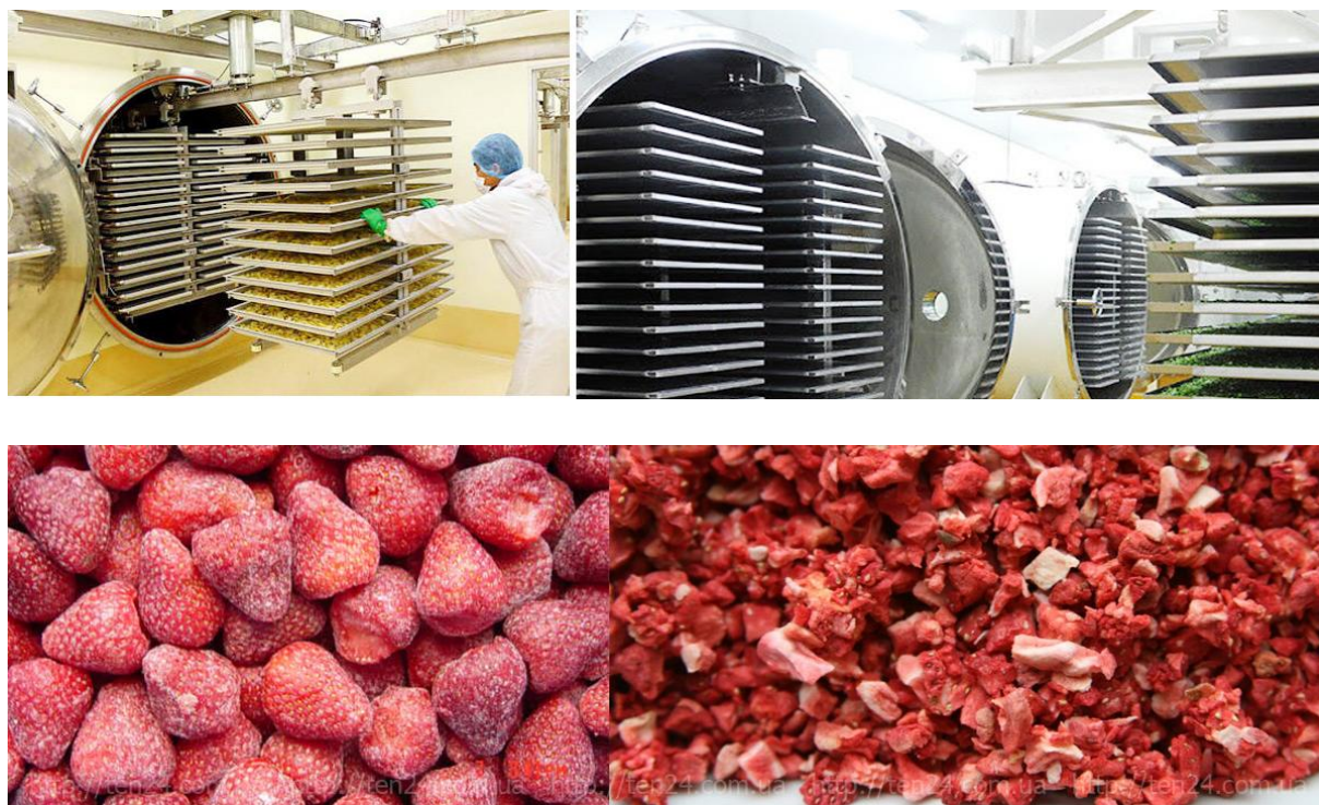
Сурет 1. Жемістерді сублимациялық кептіру технологиясы.
