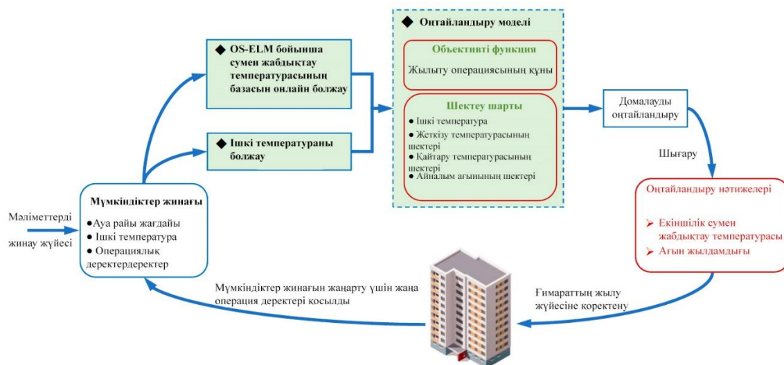
Сурет 2. Жылыту жүйесін интеграцияланған басқаруды оңтайландыру процесінің құрылымы.
