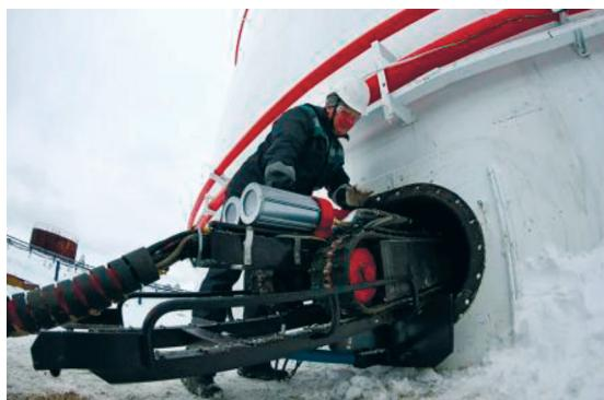
Рисунок 5. Механический метод зачистки резервуара.
