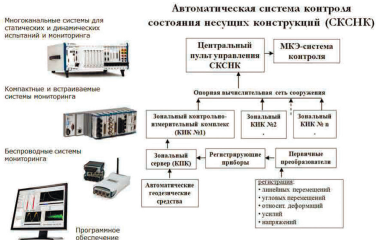
Сурет 5. Автоматты мониторинг жүйесінің компоненттері.
