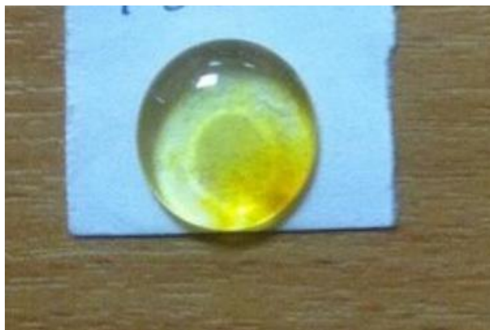
Рисунок 1. Фотография оксифторидного стекла с МК серебра и ионами самария.
